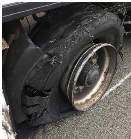
Afb. 36: doorgereden na plotseling ongecontroleerd luchtverlies.
