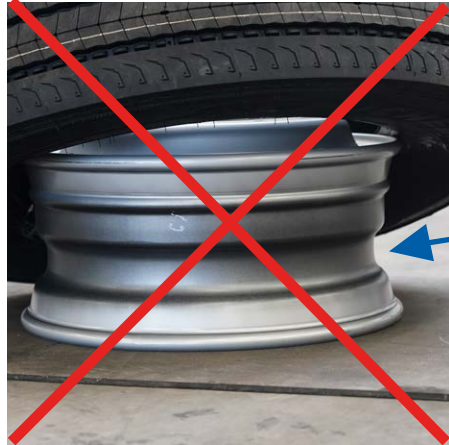
Afb. 3: velgbed zit niet aan de goede kant
