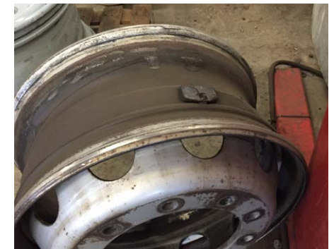
Afbeelding 0.6: TPMS sensor achter het ventiel
