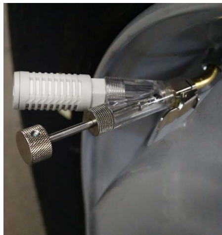
Afb. 4: geluiddemper bij leeglopen van banden
