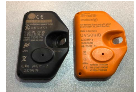
Afbeelding 0.4: TPMS sensoren achter het ventiel
