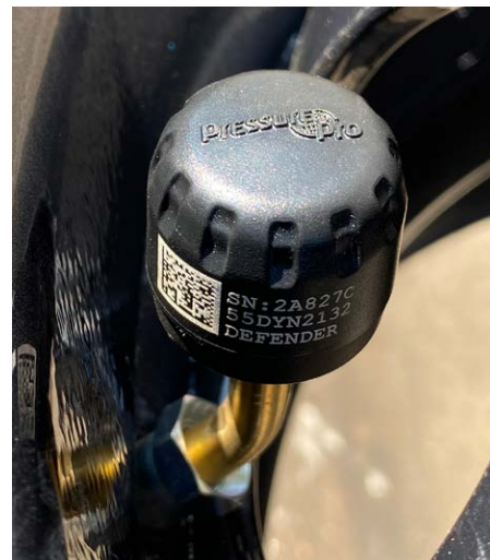
Afb. 0.3: TPMS sensor aan buitenkant ventiel
