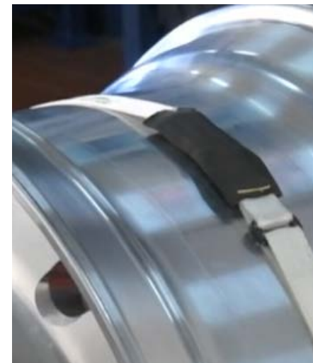
Afbeelding 0.7: TPMS sensor in diepbed
