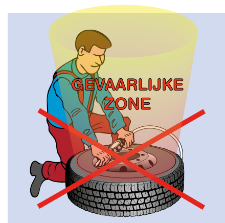
Afb. 48: leg de band nooit plat op de grond.
