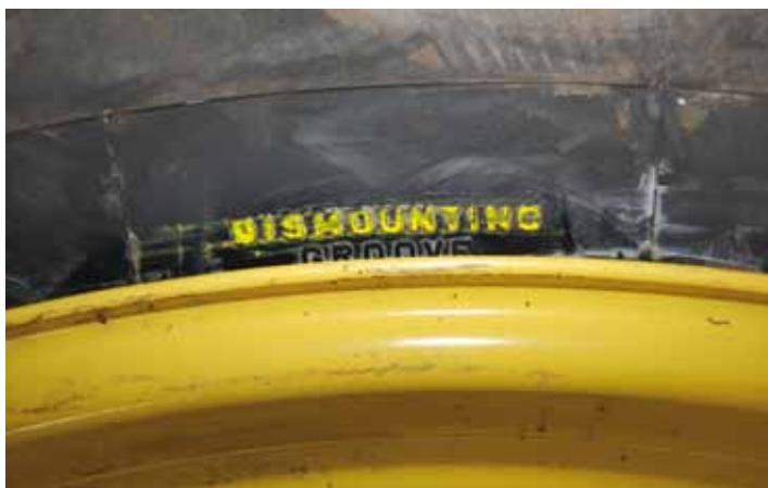
Afb. 27: Plaats voor montage hieldrukker
