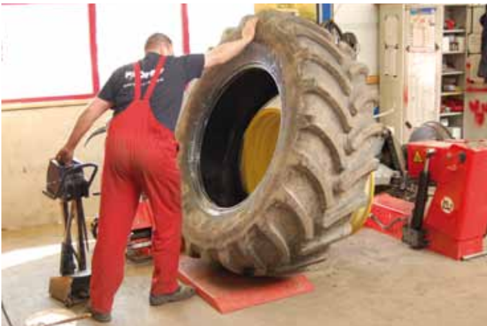
Afb. 17: band optillen in diepbed
