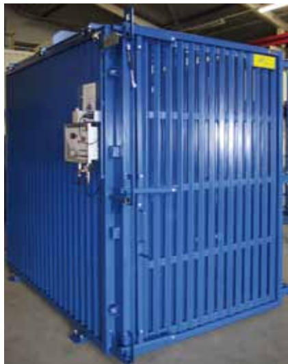
Afb. 34: bandenkooi voor losse band/wielcombinaties
