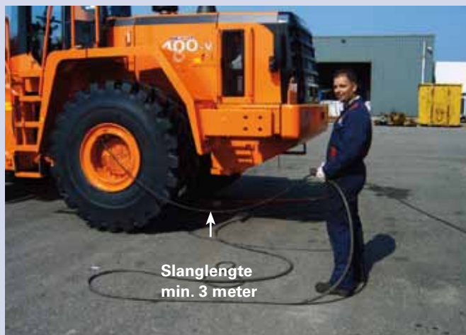
Afb. 40: op voorspanning brengen
