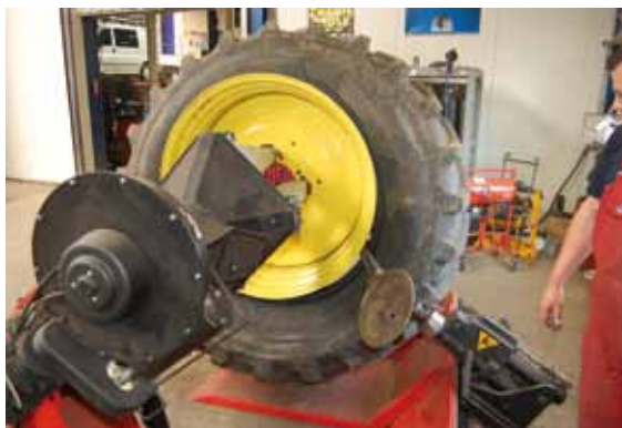
Afb. 9: tweede hiel verwijderen
