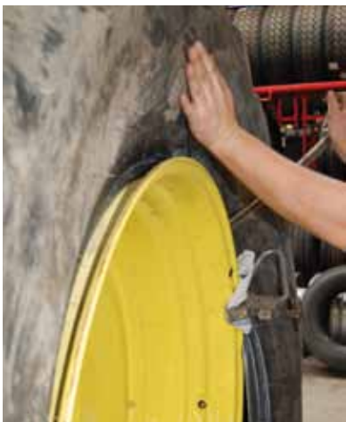
Afb. 20: band goed in het diepbed drukken
