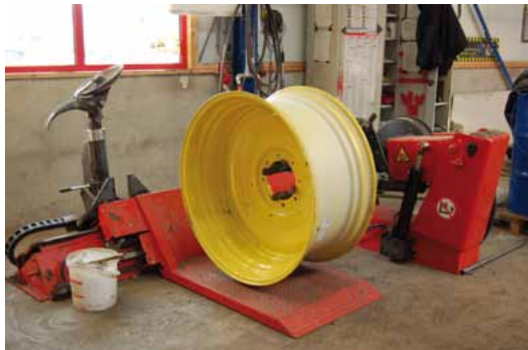
Afb. 14: opspannen van het wiel
