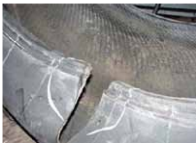
Afb. 42: band met grote kracht over veiligheidsrib gesprongen
